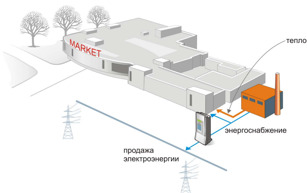
Рис. 7. Зимний режим. Ко-генерационная станция вырабатывает электроэнергию и тепло. Избыточная электроэнергия продается в общую сеть.
